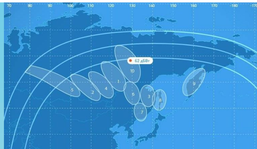
Зона покрытия спутника Экспресс-АМ5 (140° в.д.)
